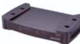
Устройство типа «все в одном» для малых офисов и предприятий: Маршрутизатор удаленного доступа ADSL/кабельных модемов + Интернет-шлюз + 8-портовый коммутатор Fast Ethernet. Расширенные функции обеспечения безопасности. SNMP и Web управление. Поддержка VPN и DMZ host.
