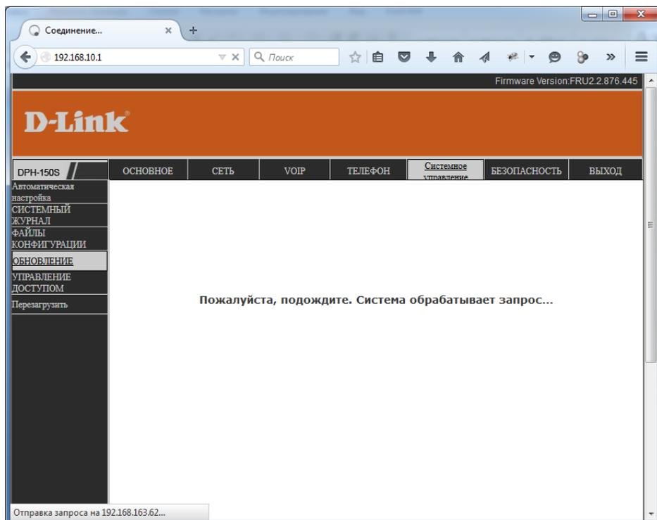
5. В процессе перепрошивки устройство перезагрузится. По завершению процесса обновления должна смениться версия текущего ПО на WEB-интерфейсе устройства (правый верхний угол страницы).
