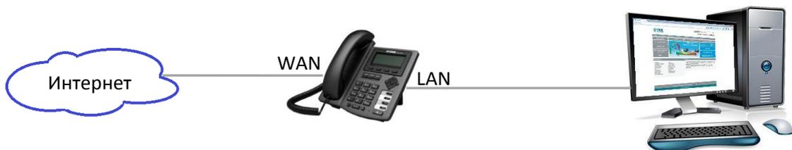
2. Зайти на WEB-интерфейс устройства, который доступен по обоим интерфейсам LAN и WAN. В примере вход осуществляется по порту LAN, для которого по умолчанию установлен IP-адрес 192.168.10.1 (DPH-150S/F4).
