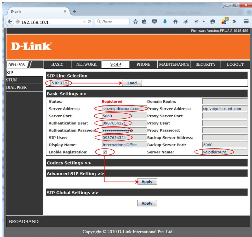
После ввода данных учётных записей от операторов телефонии и успешной регистрации телефон начинает принимать вызовы и позволяет осуществлять исходящие звонки. Выбор оператора осуществляется соответствующей телефонной клавишей Line 1, Line 2 и т.д. (зависит от аппаратной ревизии устройства). При необходимости автоматического распределения вызовов необходимо настроить маршрутизацию/обработку вызовов в меню VOIP – DEAL PEER.
