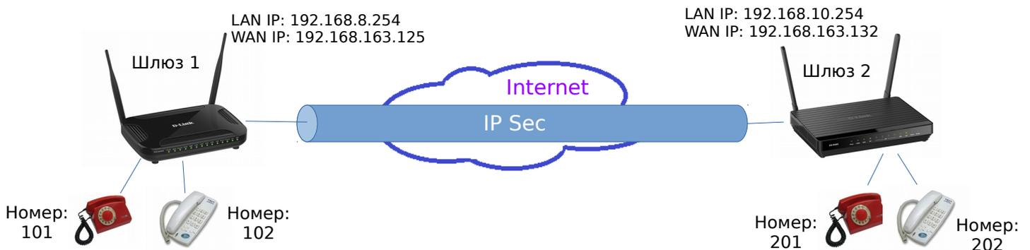
С помощью VoIP шлюзов D-Link, поддерживающих установку защищенных туннельных соединений (IPSec) можно настроить защищенное голосовое соединение между офисами в режиме точка-точка (в том числе возможен и обмен сетевым трафиком).
